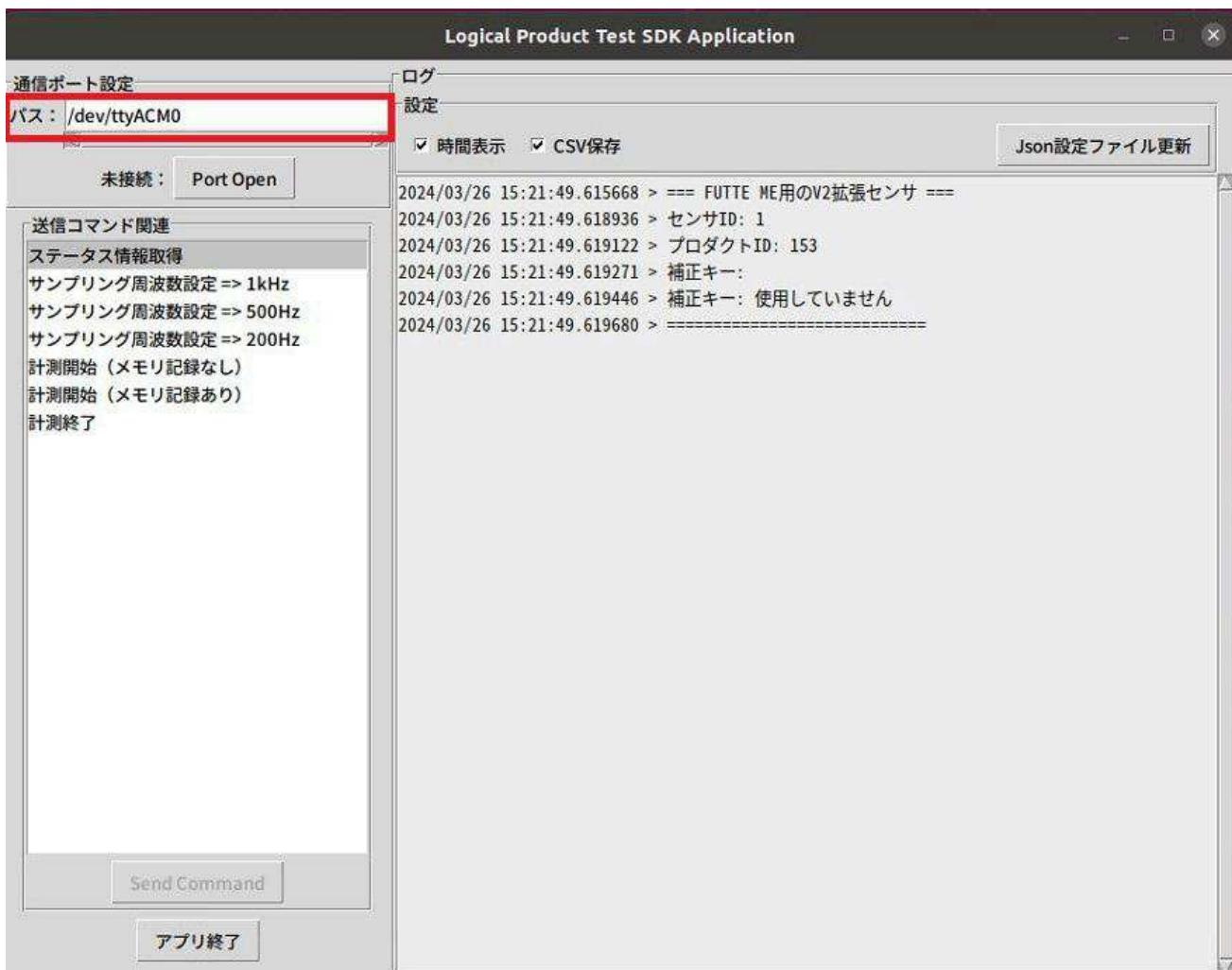
[Port Open]ボタンをクリックすると、センサが接続されているシリアルポートが開きます。シリアルポートがオープンされると、送信コマンド関連テーブルで [Send Command] ボタンをさまざまなコマンドで使用できるようになります。
