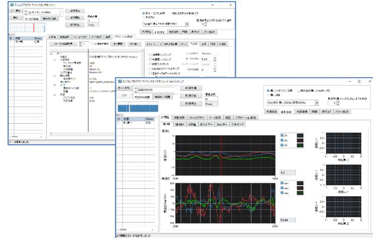
計測の開始/停止はもちろんの事、ワイヤレスセンサモジュールに搭載されているメモリのファイル管理、サンプリング周波数や測定時間などの計測設定、これらを無線接続でも、有線接続でも行うことが可能です。
